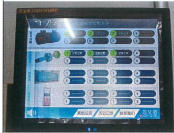
油罐—油管在线渗漏监测系统
