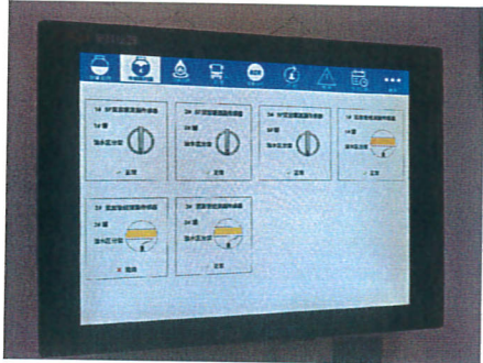
双层油罐双层管道在线渗漏监测系统
