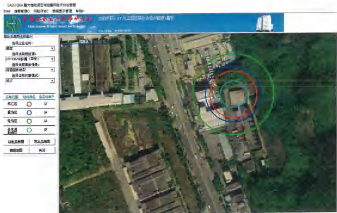
附图 4.3-1 08/20 卧罐容器整体破裂事故后果图（池火） （红：死亡区，蓝：重伤区，绿：轻伤区，湖蓝：多米诺影响区）
