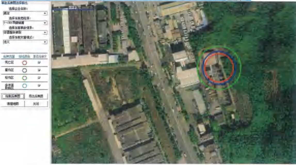
附图 4.3-4 301 甲醇储罐容器整体破裂事故后果图（池火） （红：死亡区，蓝：重伤区，绿：轻伤区）
